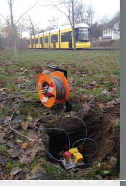
Mittels Schwingungsmessungen auf dem Baufeld werden Daten zur rechnerischen Abschätzung des Schwingungs- und Körperschalleintrags in die dort zu errichtenden Bauwerke gewonnen.
