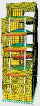
Von besonderer Bedeutung ist die Prognose der Deckenschwingungen, da letztere sowohl störende Fußbodenschwingungen als auch Sekundärluftschallabstrahlungen bewirken
